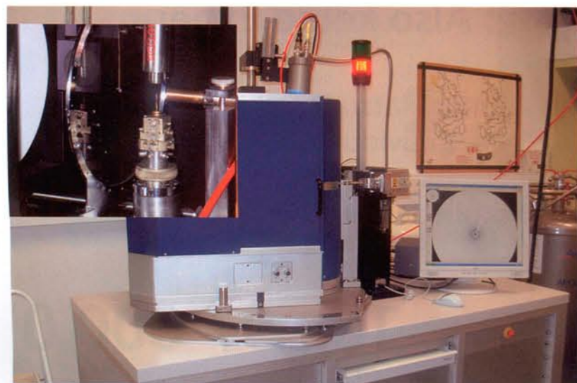
Abb. 2 Röntgendiffraktometer für die Strukturanalyse von Molekülen, links oben sieht man den Goniometerkopf, auf den ein Einkristall montiert ist.
